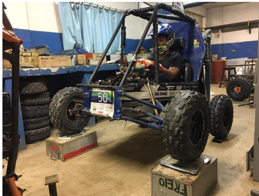
Figura 28: Teste para localização do CG
