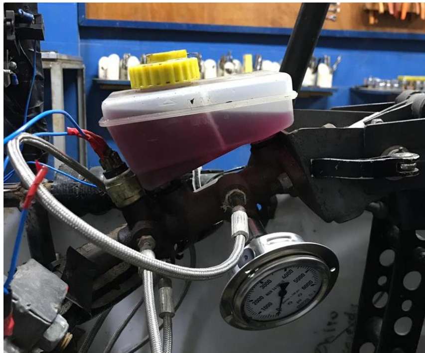
Figura 35: Manômetro instalado em uma das saídas do cilindro mestre
